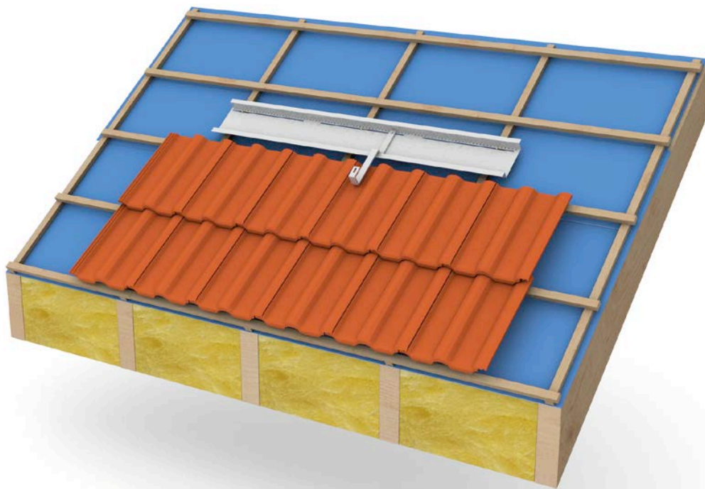
Fig. 22 Fixation d'un crochet dans un élément intermédiaire.
