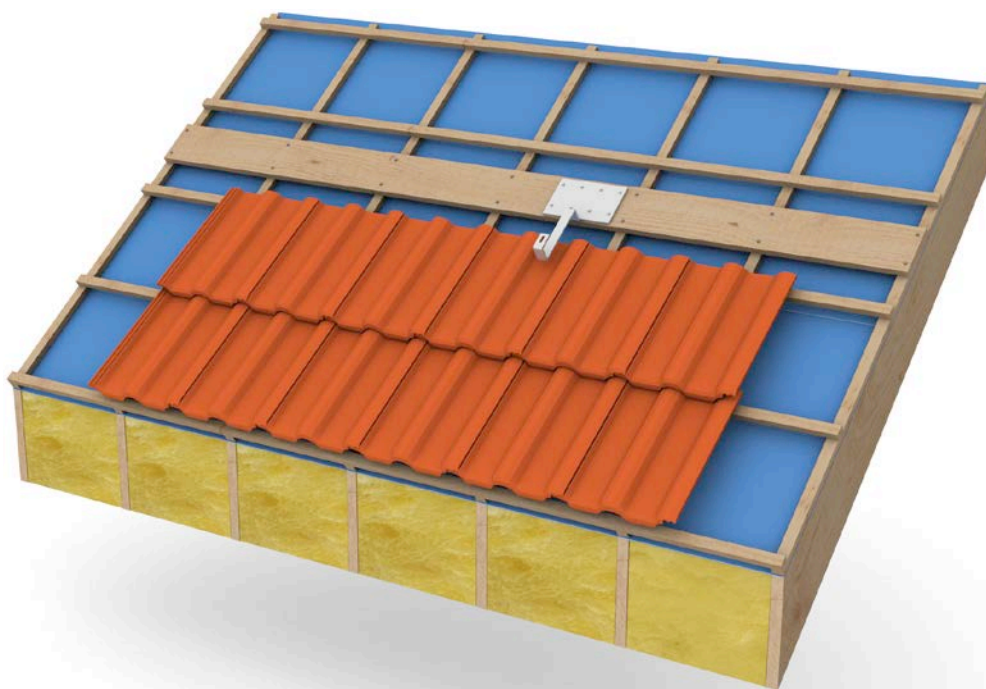
Fig. 24 Fixation d'un crochet équipé d'une platine large, permettant d'employer davantage de vis d'un diamètre inférieur.
