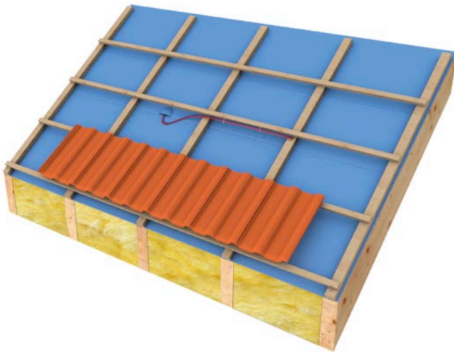
Fig. 51 Raccord au niveau des percements de la sous-toiture.
