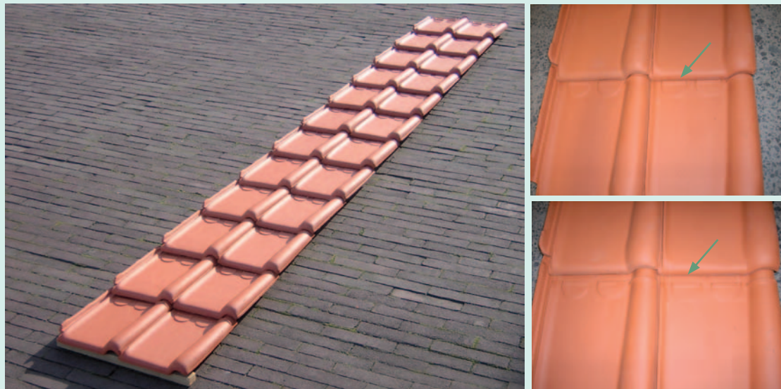
Fig. 13 Disposition des tuiles à emboîtement de tête pour la détermination de l'écartement des lattes : tuiles serrées au maximum (en haut, à droite) et étirées au maximum (en bas, à droite).
